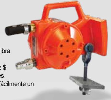
En la imagen se muestra con una ménsula opcional de anclaje para asegurar la ménsula en la cavidad de la brida.
