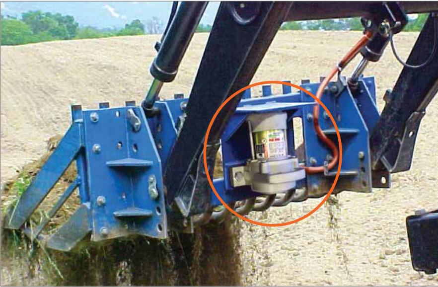
Arriba: Un **Big Bertha** se utiliza en una excavadora para retirar grandes rocas y vegetación de un sitio de trabajo y al mismo tiempo dejar el suelo en el lugar (ver páginas 48 y 49). Abajo: El **DC-3500, Big Bertha** de VIBCO se ajusta con firmeza debajo del volquete basculante de un camión y cuenta con todas las conexiones eléctricas necesarias para instalarlo y operarlo con efectividad.
