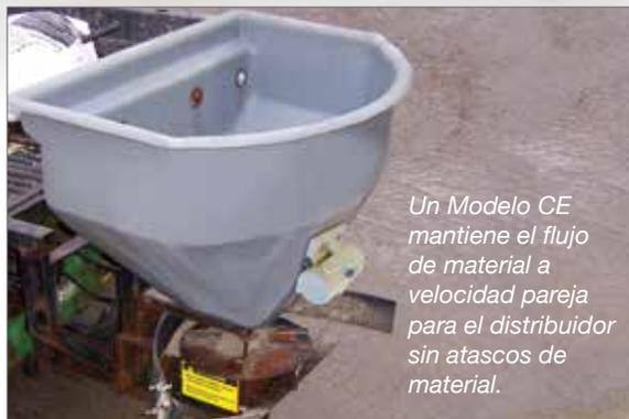
Un Modelo CE mantiene el flujo de material a velocidad pareja para el distribuidor sin atascos de material.
