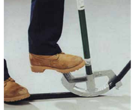
Use un adaptador Hickey para reducir la posibilidad de daño del recubrimiento de la tubería.
